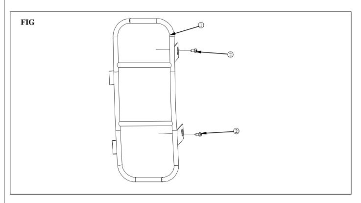
3、TEST AND MAKE SURE THAT THE TAIL LIGHT GUARD IS STEADILY FIXED.
